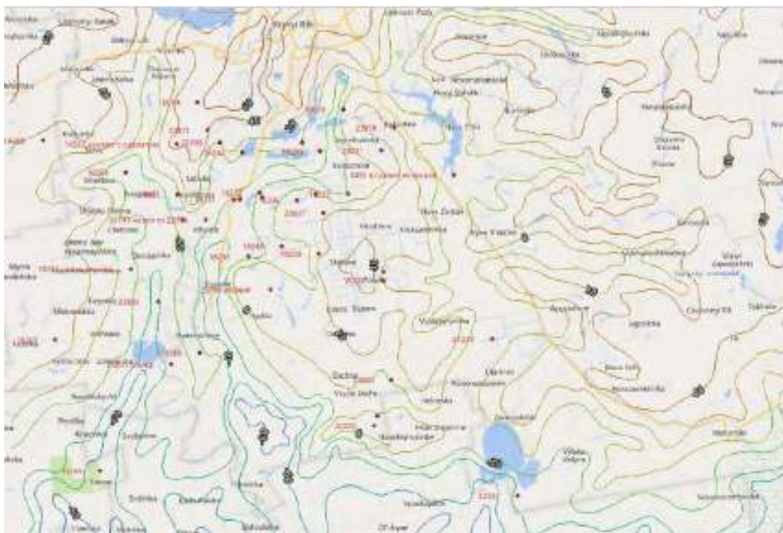
Рис. 57. Модель поверхні кристалічного фундаменту.
