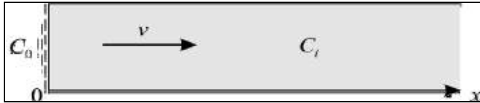
Рис. 61. Міграція в одномірному фільтраційному потоці. Напівобмежений у плані пласт.
